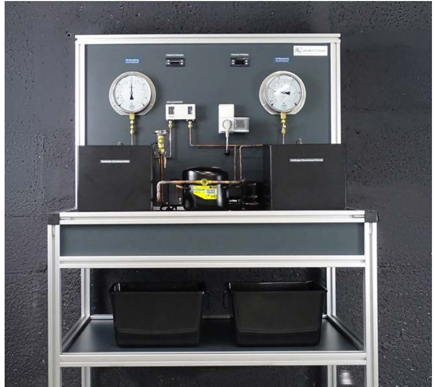
Schulungsstand Wärmepumpe, System Wasser-Wasser
