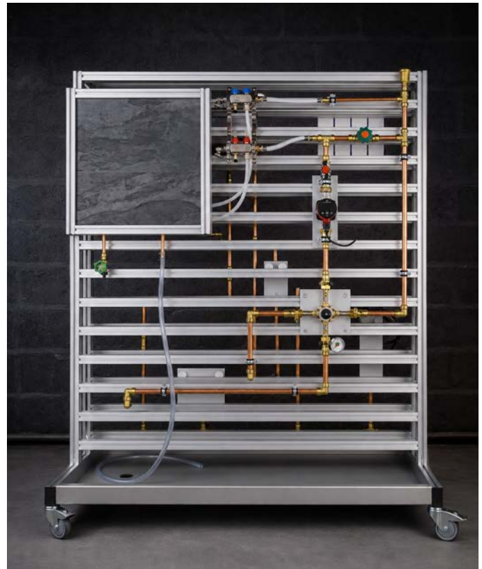
Modulsatz 2. Heizkreis aufgebaut auf dem Versuchs- und Montagewagen 571730
