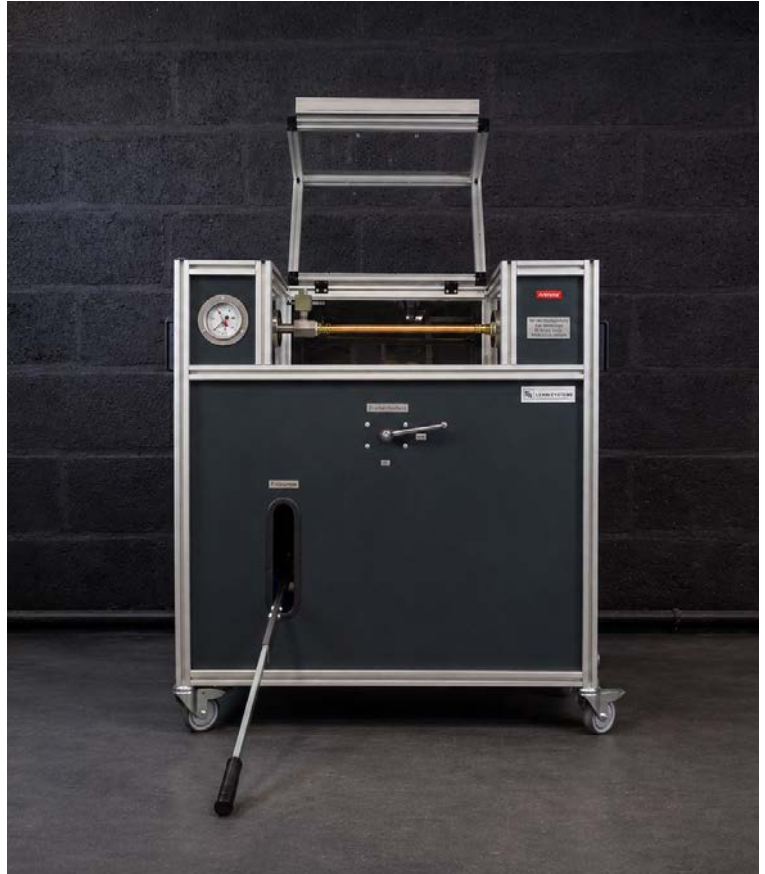
Schulungsstand Berstversuche für Rohr- und Fittingverbindungen
