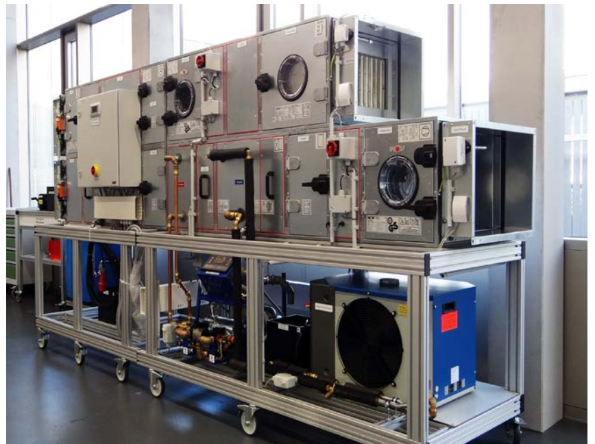
Schulungsstand Klimaanlage, Praxisausführung
