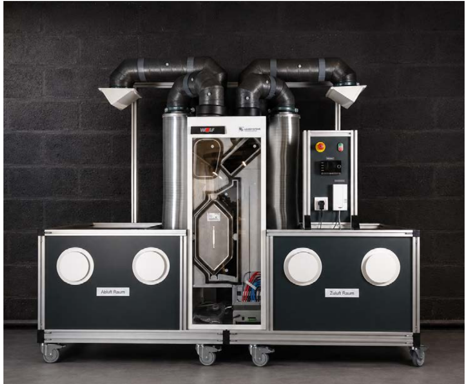
Schulungsstand Kontrollierte Wohnraumlüftung, Fabrikat Wolf
