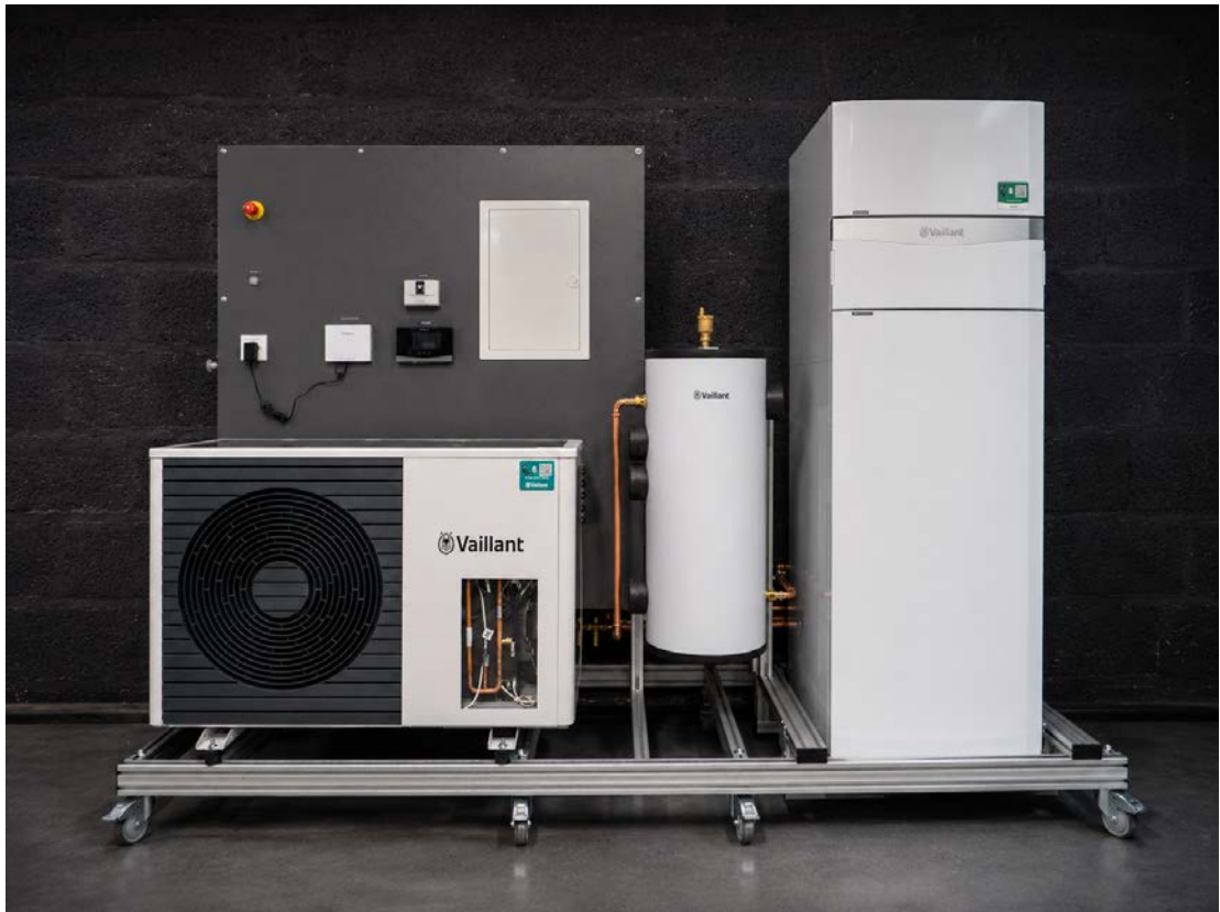
Schulungsstand Wärmepumpe Monoblock mit Brauchwasserspeicher
