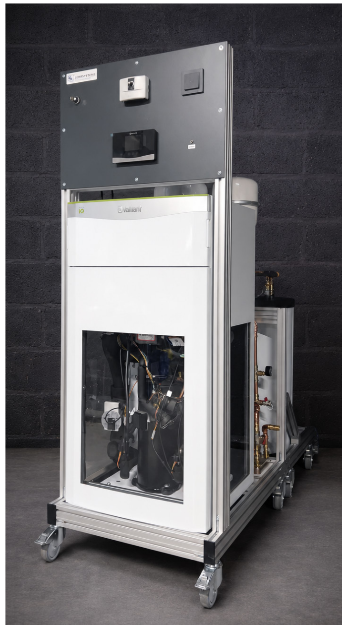
Schulungsstand Wärmepumpe, Industrieausführung
